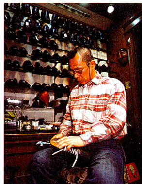
「ワニ」と呼ばれるベンチのような専用道具で革を引っ張り、止め釘を打っていく。かかとのシルエットは木型を駆使して慎重に整えていく。
