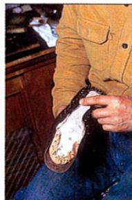
4枚の革を重ね、木型に被せて引っ張り、甲を上げる作業「吊り込み」。丁寧に作られた靴を象徴する重要なパートである。革の引っ張り具合、釘の打ち方ひとつでフィット感が変わってくる。居つきのよさはここで決まる。
