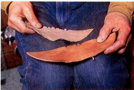
カカトの芯革、腰玉の加工前と加工後、手前が元々のサイズで福島さんが顧客のカカトに合わせて水に浸したり、削ったり鋸いたりしてジャストフィットする腰玉を作り出す。根気のいる作業だ。
